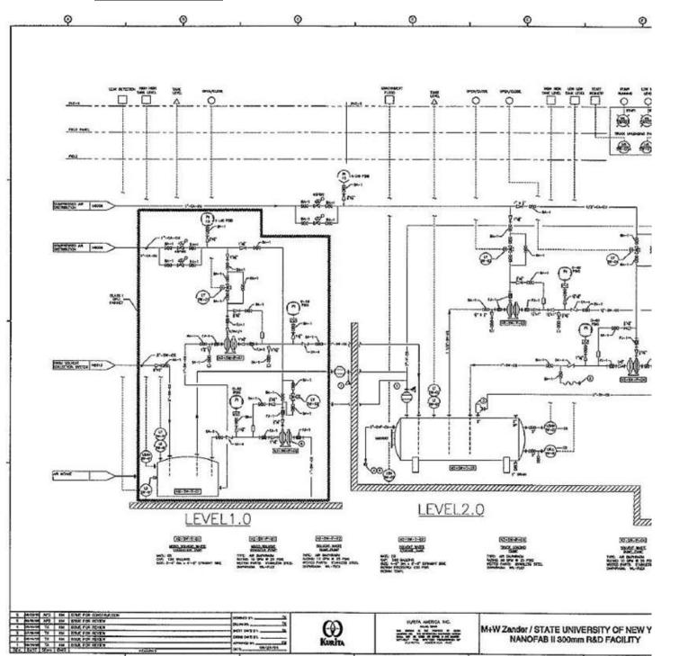
ATTACHMENT 2 – MECHANICAL SOLVENT WASTE SYSTEM STORAGE PROCESS AND INSTRUMENTATION DIAGRAM
